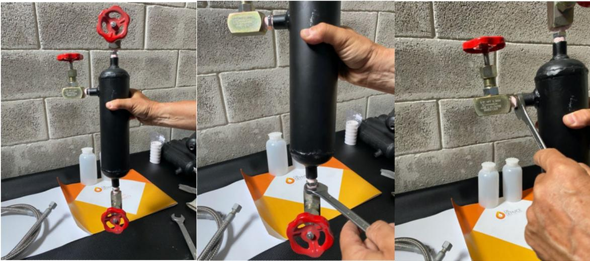
4. Una volta assemblate tutte le valvole sul barilotto nero, mettere il teflon solo su un filetto del raccordo in acciaio conico e serrare bene
